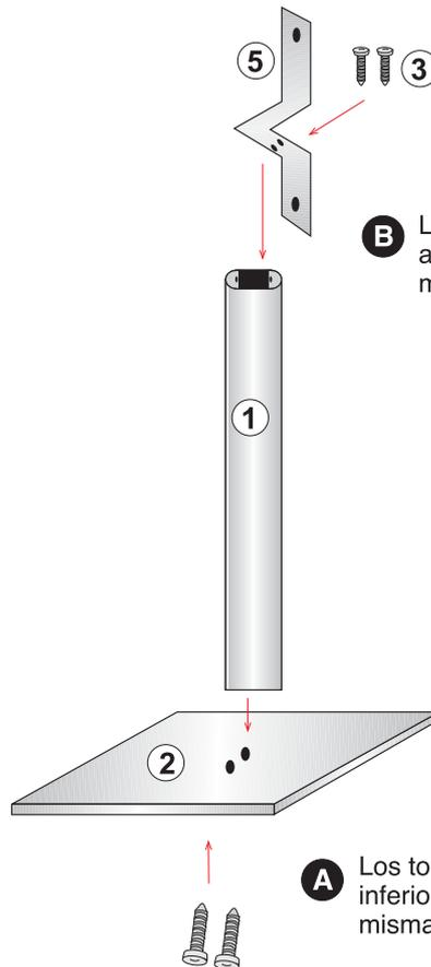
**B** Los tornillos tendrán que atornillarse en el soporte del marco y en el mástil.
