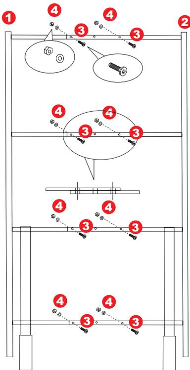
**4** Colocación de un lateral del Panel vertical sobre la estructura del expositor.
