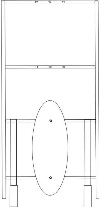
**2** Separación de las piezas de la estructura de embalaje: Extracción de los latiguillos. Desatornillar los tornillos que se utilizan posteriormente para montaje.
