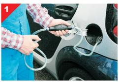
Introducir el extremo de la manguera colocado en el lado opuesto al que señala la flecha de dirección de la bomba en el depósito de combustible.
