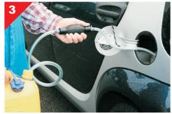
Cuando el líquido empieza a fluir, introducir el final de la manguera en un contenedor y seguir apretando la bomba hasta que se vacie el depósito a vaciar.
