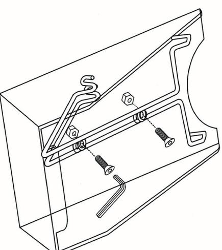
Unión de la bandeja con el soporte metálico
