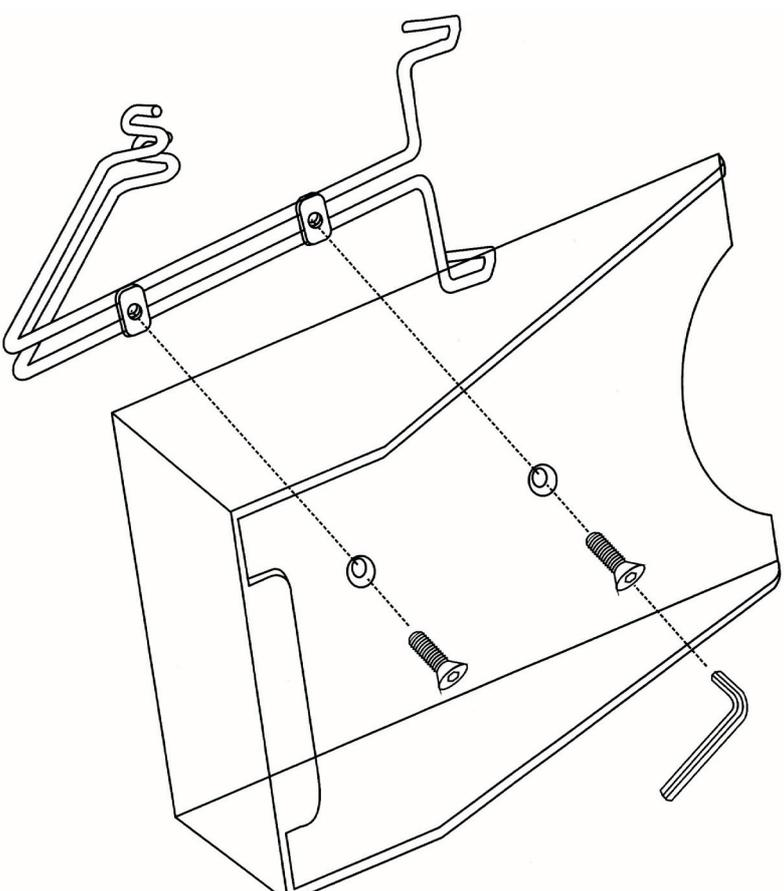
Unión de la bandeja con el soporte metálico para anclaje en el expositor.
