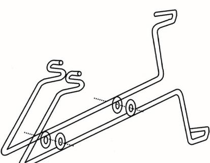
Montaje del soporte metálico para anclaje en el expositor.
