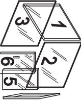
**7** → DEBE INSERTAR LOS CRISTALES EN LA RANURA INTERNA QUE HAY EN LA MOLDURA EN EL ORDEN INDICADO
