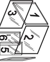
**4** → DEBE INSERTAR LOS CRISTALES EN LA RANURA INTERNA QUE HAY EN LA MOLDURA EN EL ORDEN INDICADO
